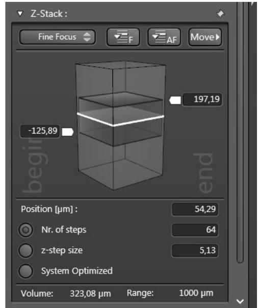
Fig. 12: Definición de la pila Z
